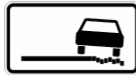
Z. 1052-38 schlechter Fahrbahnrand
